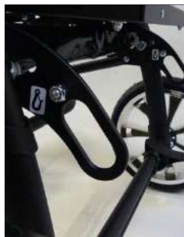
Points de fixation arrière selon ISO 7176-19
