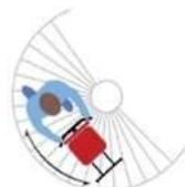
Escalier en colimaçon
