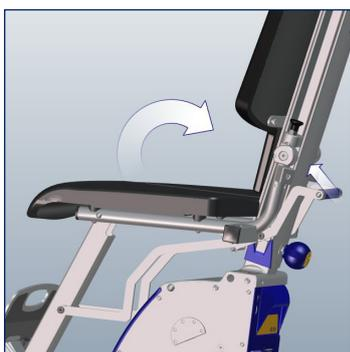
Entriegelungshebel ②③ in Richtung Rückenpolster drücken und Sitzeinheit nach oben klappen.
