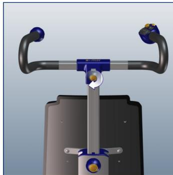
Feststellschraube im Uhrzeigersinn festziehen.
