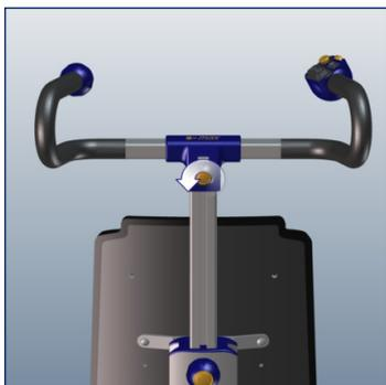
Feststellschraube für Querverstellung entgegen dem Uhrzeigersinn drehen.
