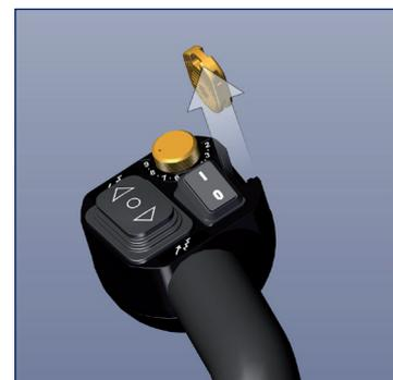
Sicherheitschip für Wegfahrsperrung abziehen.
