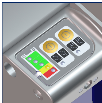
Indicateur de batterie Jaune = faible » Charger la batterie !
