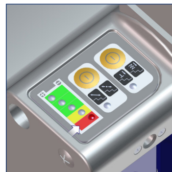
Rouge = déchargée » Charger la batterie ! » Signal sonore toutes les 12 secondes ! » La capacité de la batterie est suffisante pour 20 à 35 marches max. !
