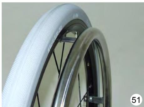
Il existe des cerceaux avec un diamètre standard (52 G) ou un plus grand diamètre (52 D).
