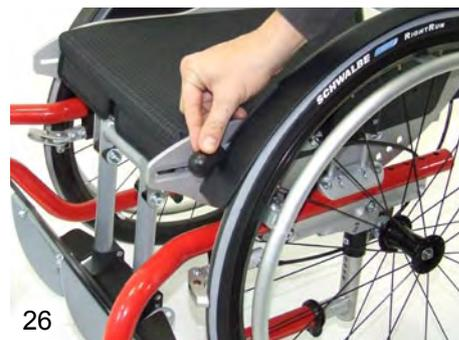
Le frein agit sur le pneu. Il doit être positionné afin d'appuyer correctement sur le centre du pneu et doit dépasser le centre de la roue de 3-5 mm.
