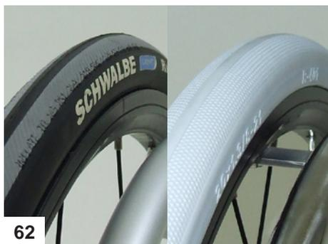
Les roues peuvent aussi être équipées de pneus pleins (62 droite).
