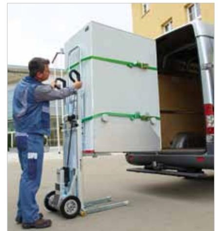
Le gerbeur électrique permet le chargement d'un camion.
